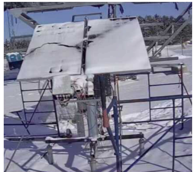
Figure 3 : Exemple de dispositif expérimental permettant d'étudier l'enneigement des modules photovoltaïques (gauche) : schéma ; (droite) système actuellement en place
